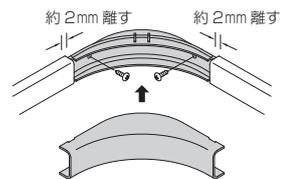
ベースにモールを2mm程度離して配置し、カバーをはめ込みます。
