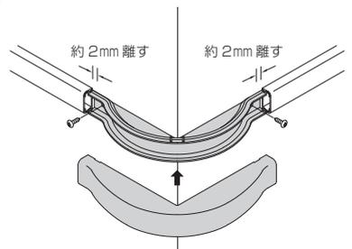
ベースにモールを2mm程度離して配置し、カバーをはめ込みます。
