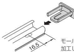
モールのベースに約φ5の穴を加工して、挿込みます。
