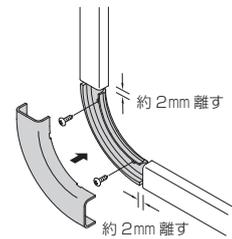
ベースにモールを2mm程度離して配置し、カバーをはめ込みます。
